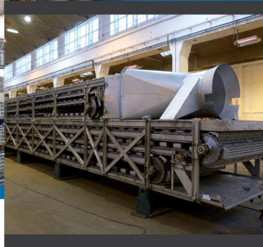
Bancada interna con modulo de sobre presión
