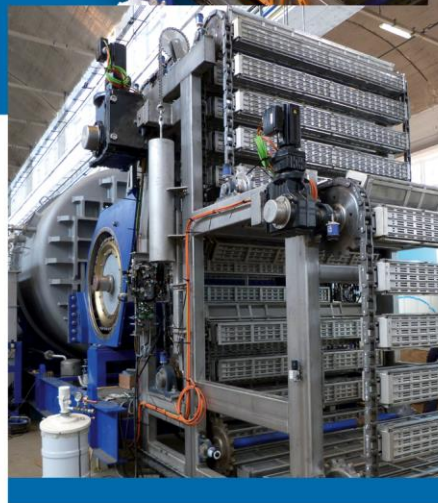
Vista de zona de carga y descarga de embases
