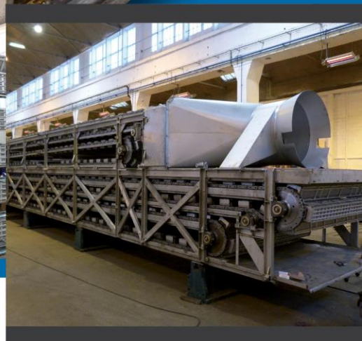
Châssis interne avec module de surpression
